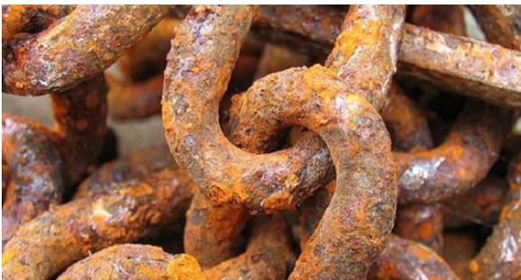
**Figura 6:** Ferrugem, causada pela formação do óxido de ferro (Fonte: <https://www.estudopratico.com.br>)
